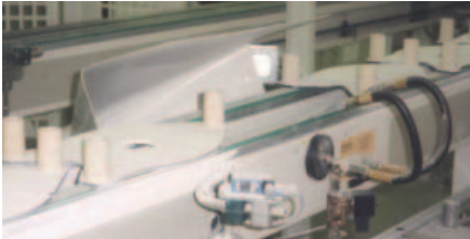
Kombinierte Blas-/Saugvorrichtung zur Reinigung von Brennhilfsmitteln
