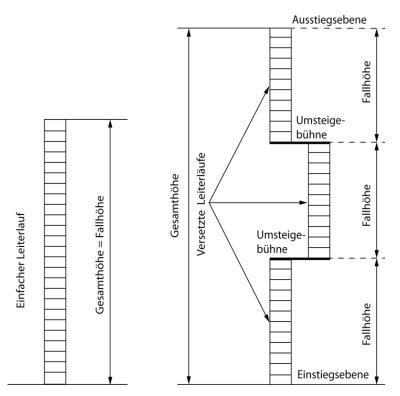
Abb. 1: Beispiel: Fallhöhe, Einstiegsebene bei Steigleitern
