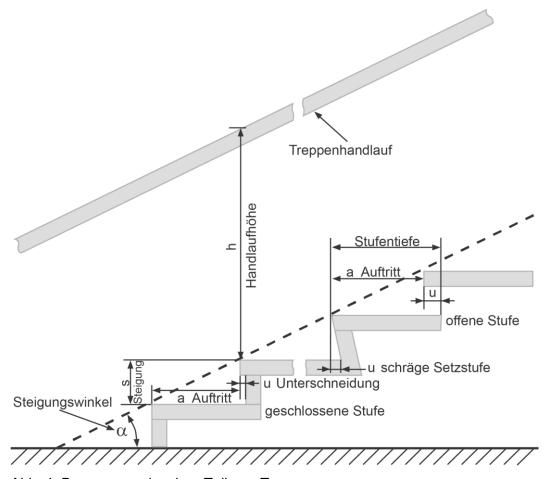
Abb. 4: Benennung einzelner Teile an Treppen
